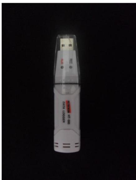
Foto 04: termohigrômetro HT-500. Fonte: autor
