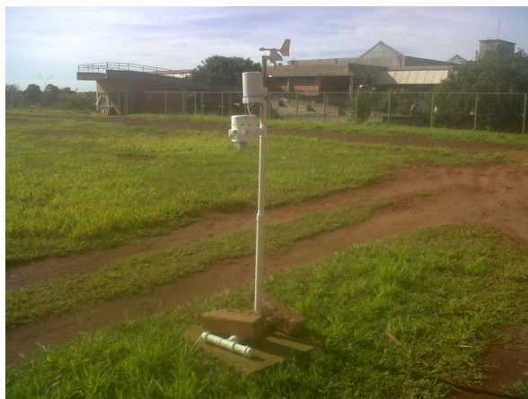
Figura 2 – Exemplo de mini-abrigo instalado na Universidade Católica Dom Bosco, Campo Grande/MS.
