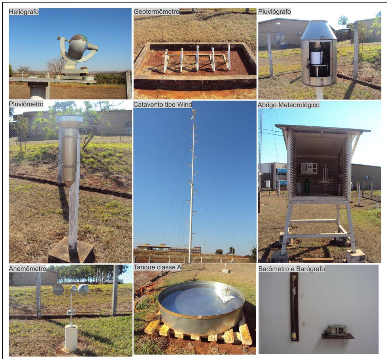
Figura 6 – Aparelhos da Estação Meteorológica-INMET
