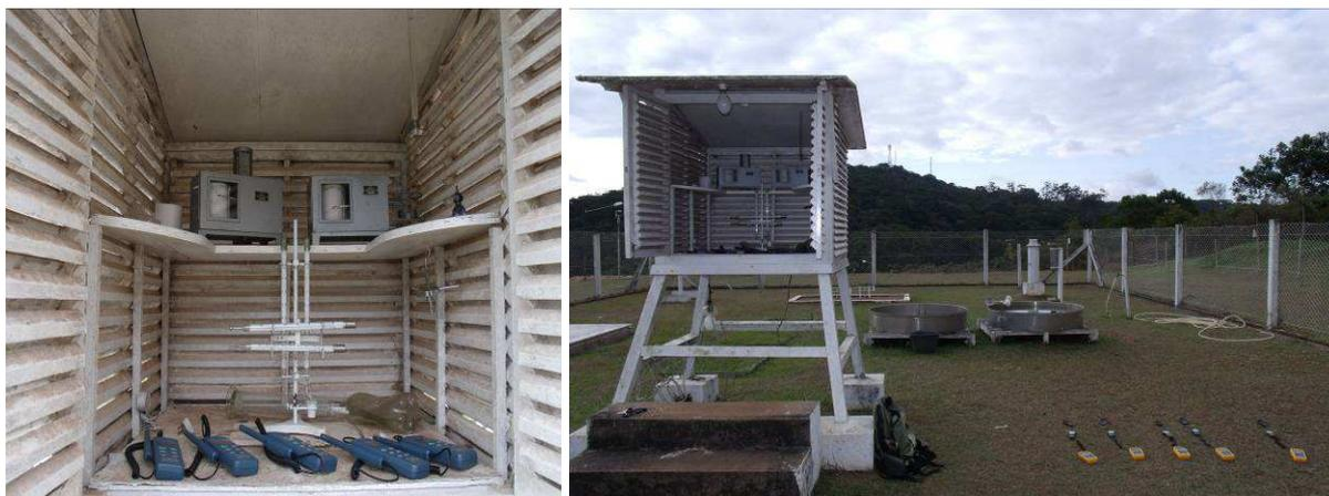
**Figura 3.** Termohigrômetros colocados dentro do abrigo da Estação Meteorológica da Universidade Federal de Viçosa e Luxímetros colocados no solo, expostos ao tempo, para aferição.
