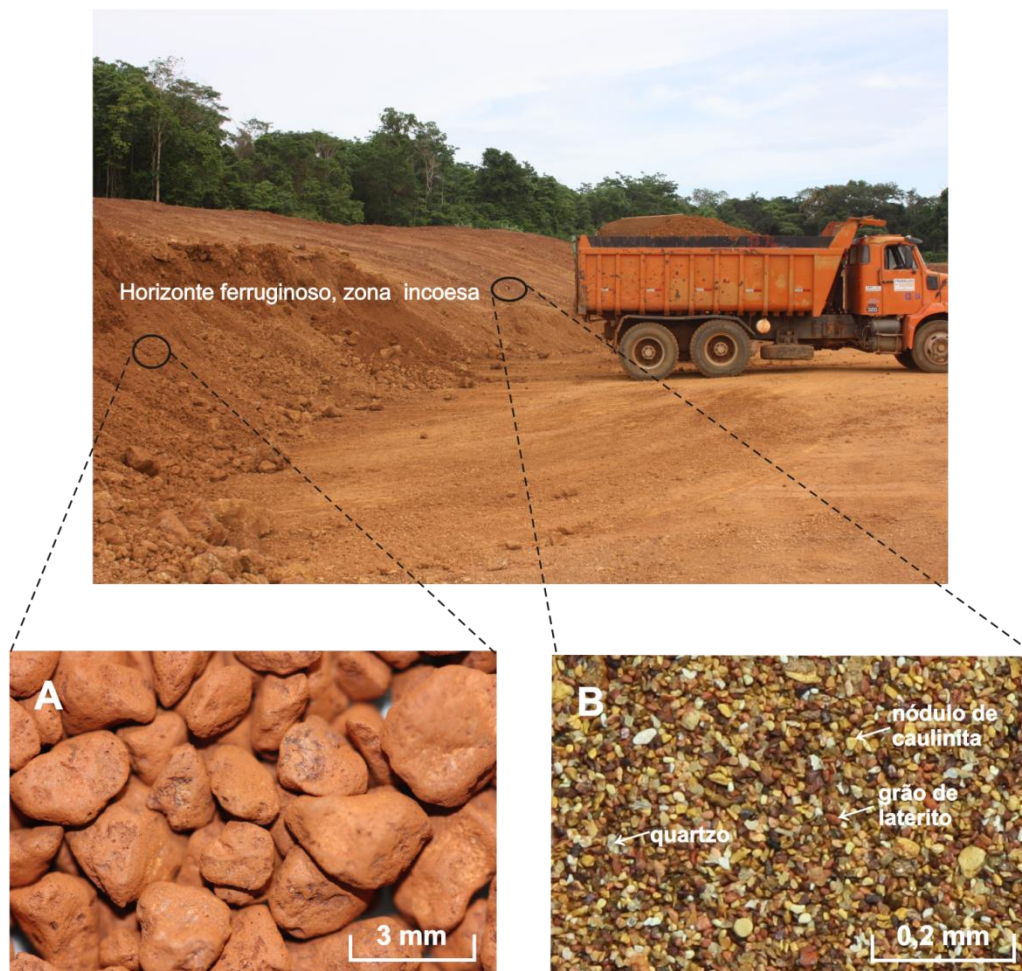
Figura 3. Lavra do material incoeso laterítico, atualmente sendo utilizado como material de sub base para a BR-319. Detalhe em (A) dos grãos arredondados da fração grânulo (4 a 2 mm), e em (B) o enriquecimento em quartzo na fração areia muito fina (0,115 a 0,07 mm).
