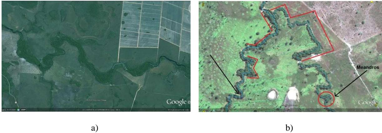
Figura 4 – Anomalias no padrão de drenagem. a) alternâncias de padrões meandrante com retilíneo; b) controle estrutural dos ângulos de bifurcação dos canais
