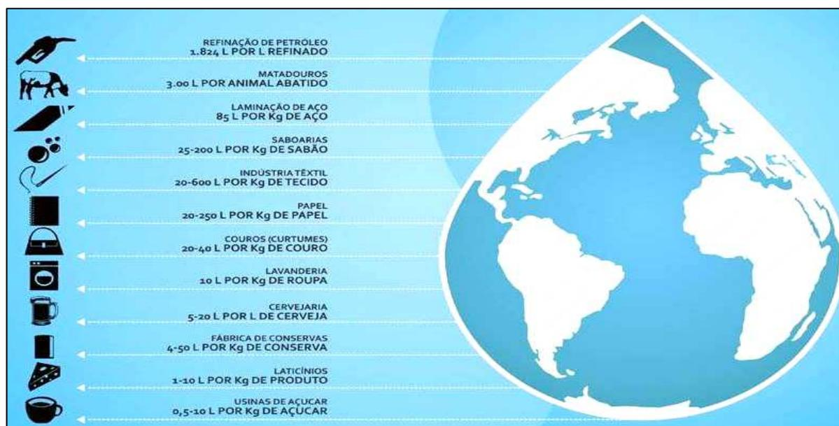
Figura 2- Quantidade média de “água virtual” (em litros) necessária à produção de uma unidade de peso (Kilograma ou litro) de produto. Este valor pode ser alterado para mais ou para menos em função das condições de produção.
