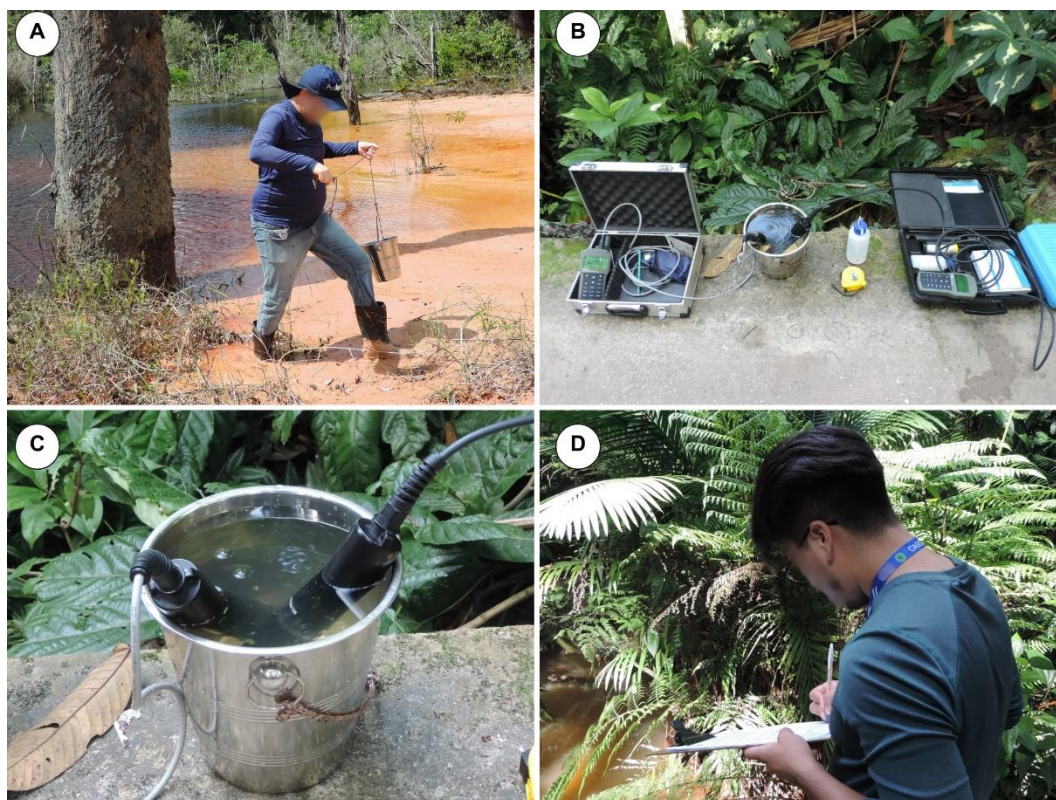
Figura 3. Coleta in loco . Legenda: A: Coleta com o balde de inox. B: Multiparâmetro (HI98194) com sonda (HI7698194) e Turbidímetro portátil (HI93703C). C: Análise d'água. D: Anotação dos resultados em fichas. Fonte: Os autores (2025).
