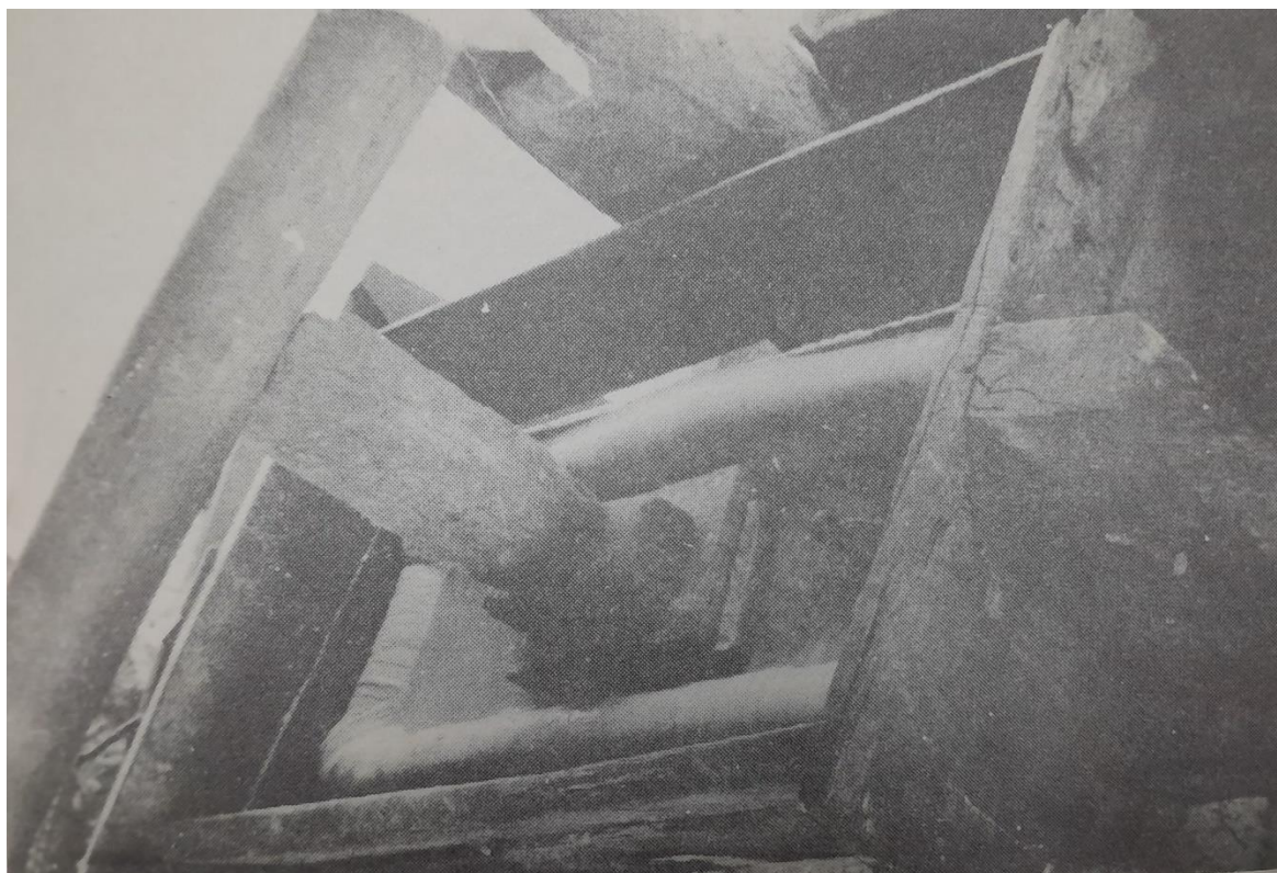
A prensa de madeira para “prensar” a massa e extrair tucupi.
