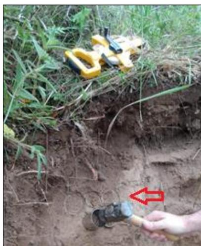
**Figura 3.** Coleta de amostras indeformadas em cilindro volumétrico tipo Uhland. **Fonte:** Os autores
