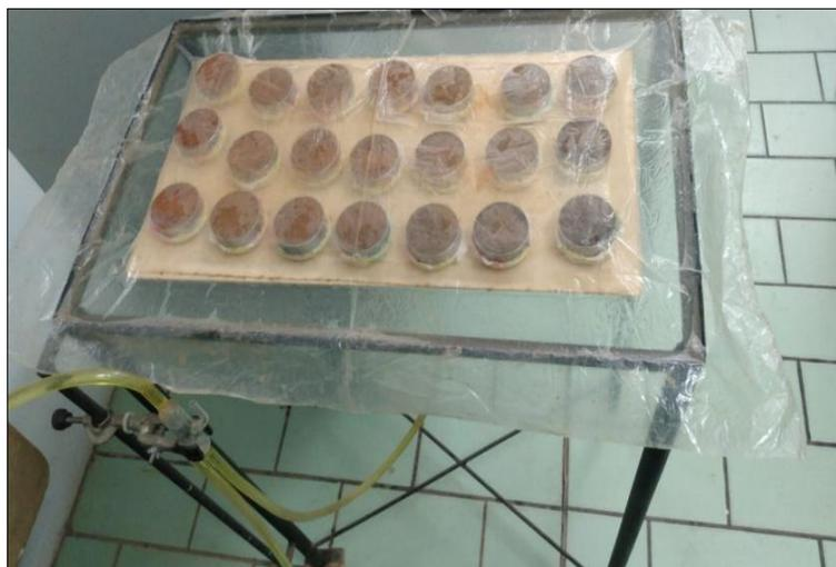
**Figura 5.** Condução do ensaio na mesa de tensão para determinação da percentagem de microporos, percentagem de macroporos e porosidade total. **Fonte:** Os autores
