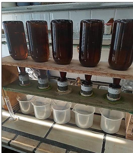
**Figura 6.** Condução do ensaio na mesa de tensão para determinação da percentagem de microporos, percentagem de macroporos e porosidade total. **Fonte:** Os autores
