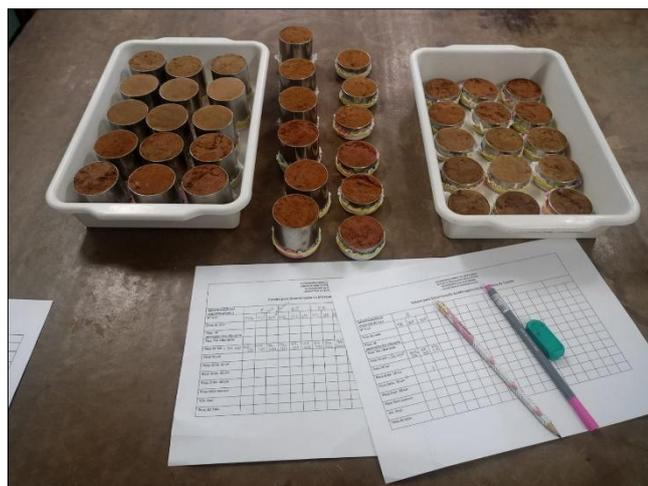
**Figura 4.** Tratamento de saturação das amostras indeformadas para a condução dos ensaios micro e macroporosidade, porosidade total (n) e condutividade hidráulica saturada (Ksat). **Fonte:** Os autores
