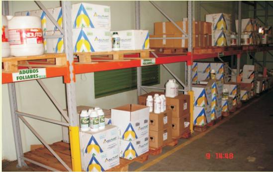
O local para armazenamento de agrotóxicos deve ser construído em alvenaria, ter boa ventilação, não permitindo o acesso de animais e pessoas não autorizadas. O piso deve ser cimentado e o telhado resistente, as instalações elétricas devem estar em bom estado. Deve ter afixadas placas com símbolos de perigo.
