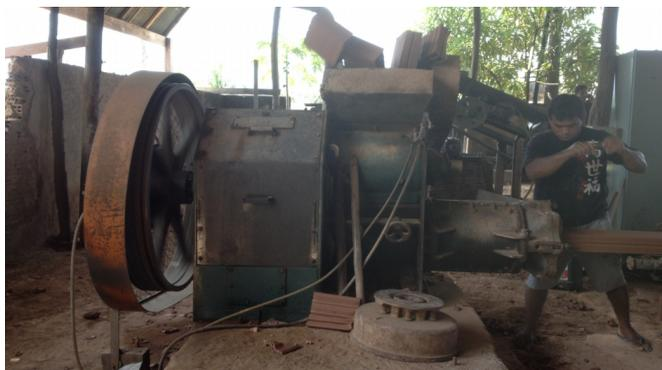
Figura 1 – Maromba usada na fabricação de tijolos em Iranduba
