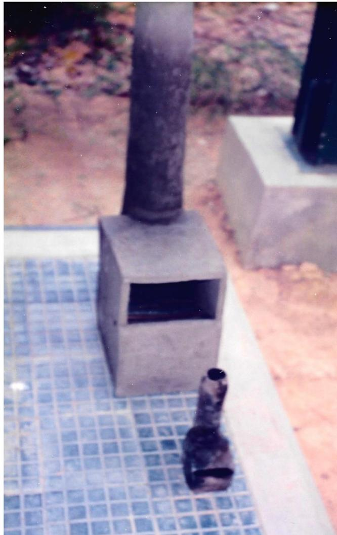
**Figura 2.** Protótipo de queimador desenvolvido em Manaus a partir do modelo em escala.
