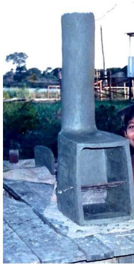
**Figura 4.** Protótipo de queimador desenvolvido pelas artesãs em Mocambo
