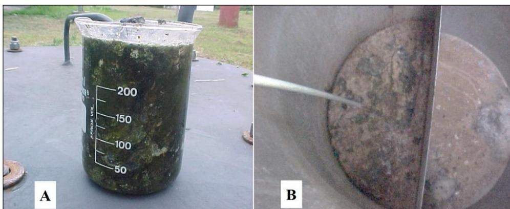
**Figura 4.** Abertura do biodigestor indiano após o processo de digestão anaeróbia do aguapé.
