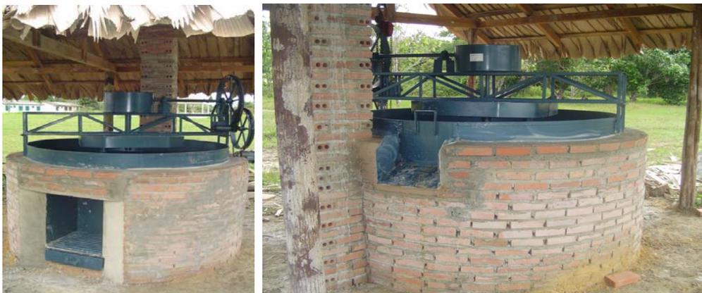
**Figura 7.** Vista frontal e traseira do forno de farinha incorporando o processo de queima invertida, entre outras melhorias (tacho mecanizado).
