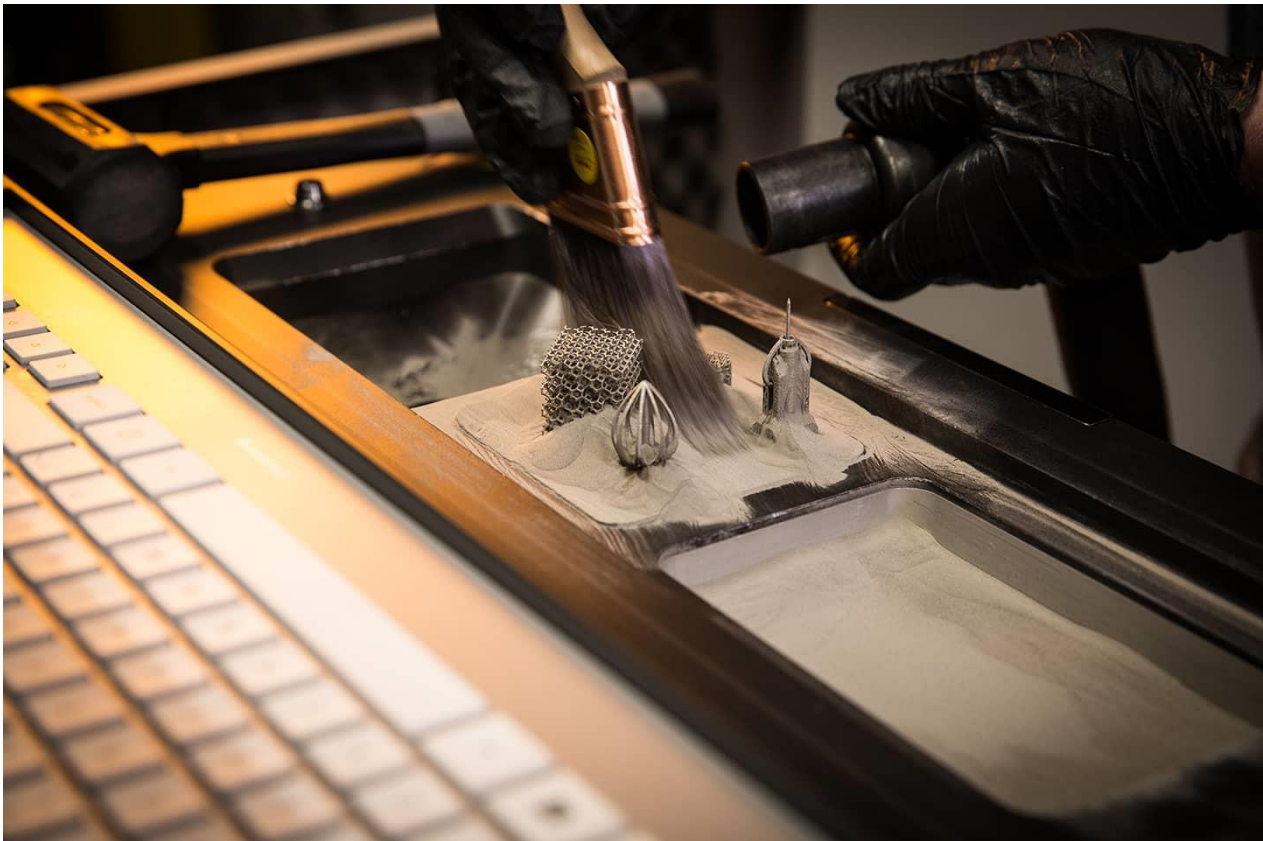
Figura 1 – Processo com tecnologia Direct Metal Laser Sintering (DMLS).
