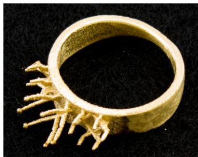
Figura 18 - Anel impresso em ouro 18k por SLM, ainda sem as pedras cravejadas
