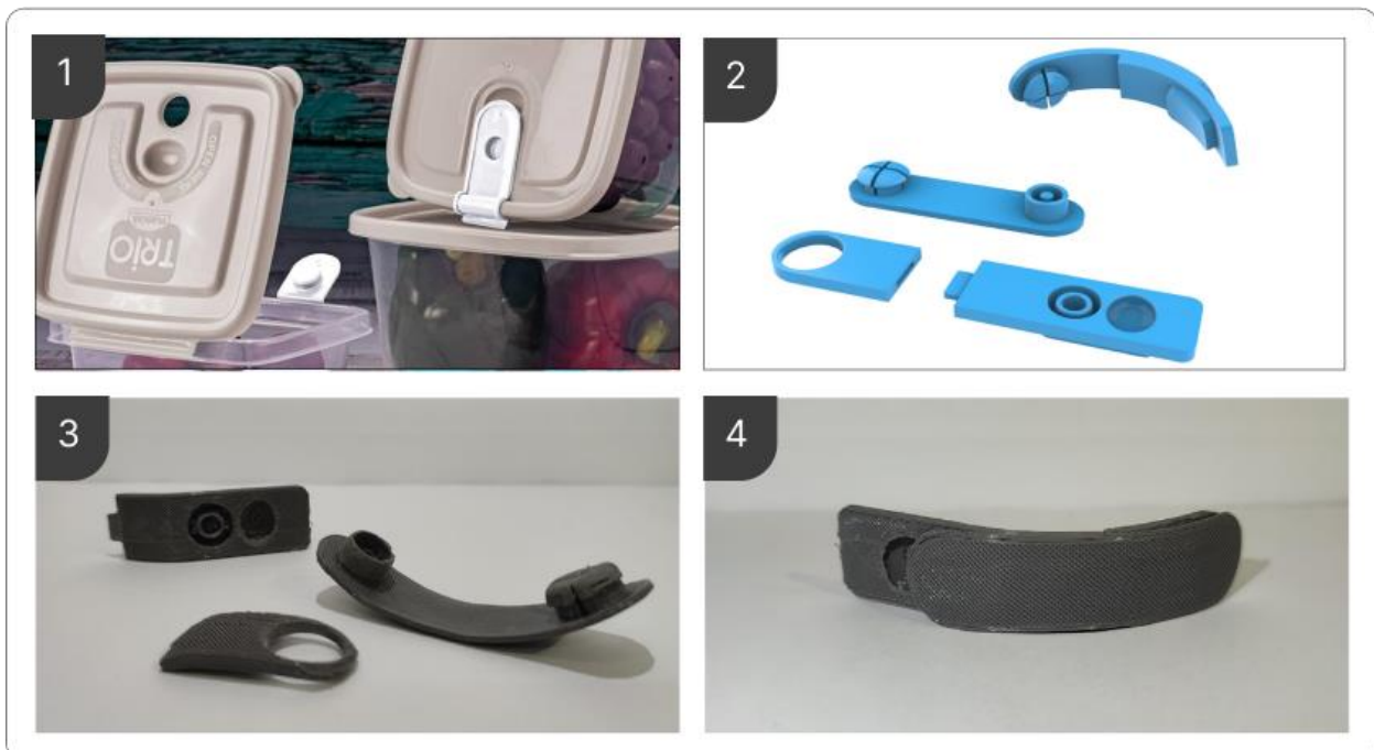
Figura 10: (1) Modelo de referência / 2 Modelagem digital do sistema junção-cancela / 3 e 4 Sistema impresso em 3D
