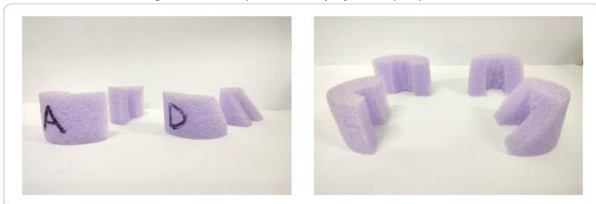
Figura 3: Modelos para testes de junção da capa à prótese
