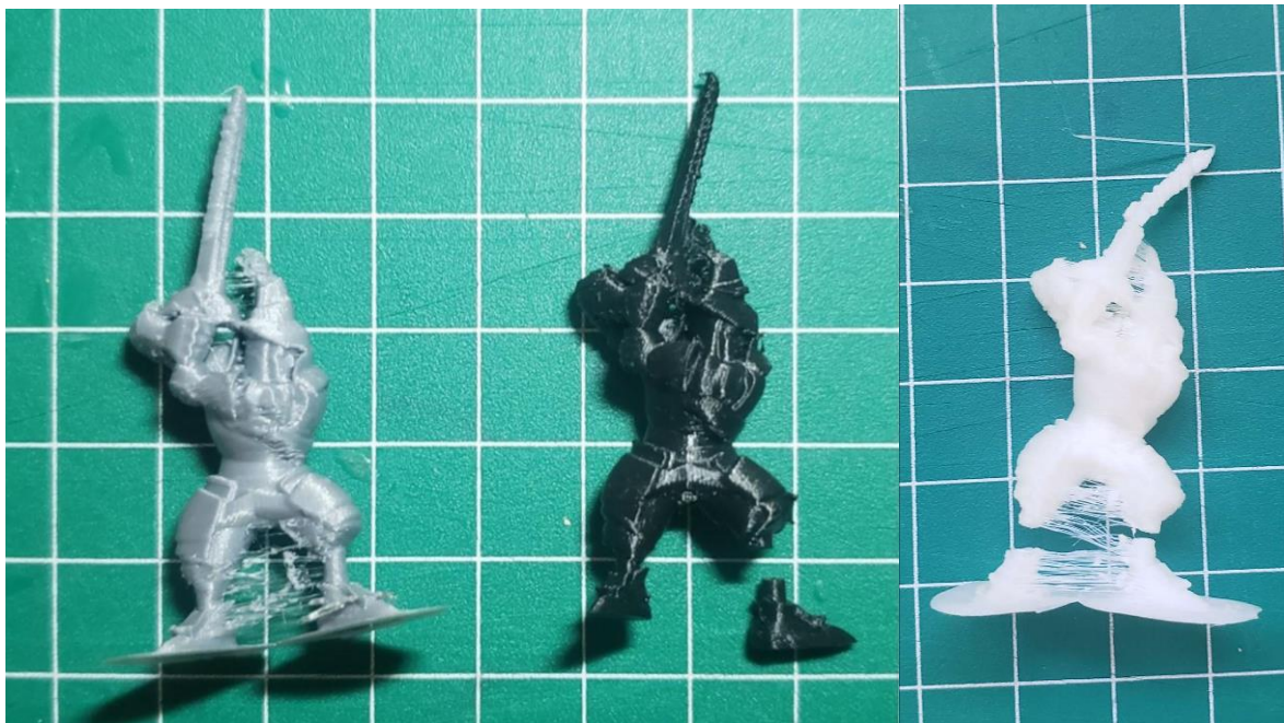
Figura 18 - Resultados impressos na Prusa MK3S de bico 0.4.
