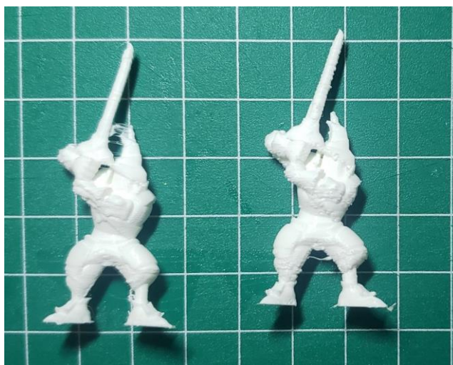
Figura 19 - Resultados da Prusa MK3S de bico 0.4 (esquerda) e Ender 3 de Bico 0.4 com filamento novo (direita)
