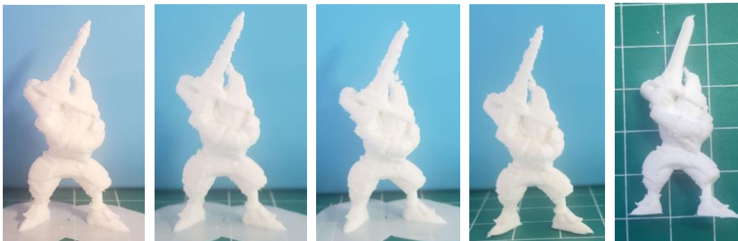
Da esquerda para a direita: A) Impressão com posicionamento corrigido. B) Impressão com o Z-hop habilitado. C) Impressão com tempo mínimo de camada reduzido para 7 segundos. D) Impressão com velocidade de impressão reduzida para 20mm/s. E) Impressão com Z-seam configurada para shortest.
