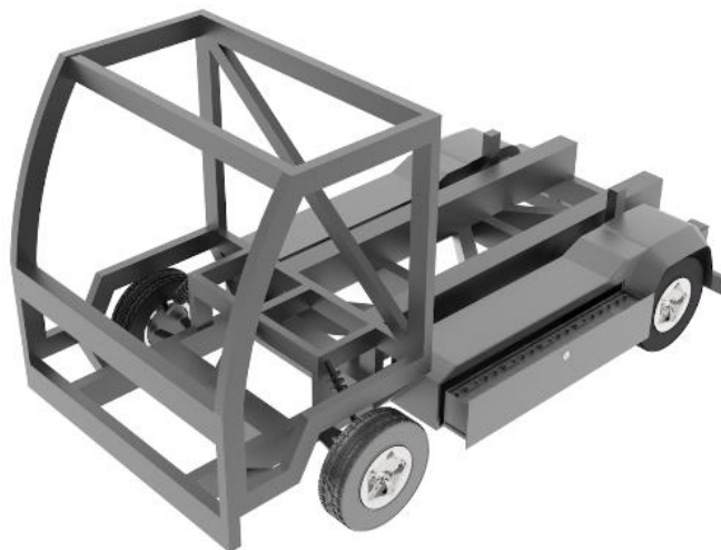
Figura 18 – Gaveta das baterias aberta.
